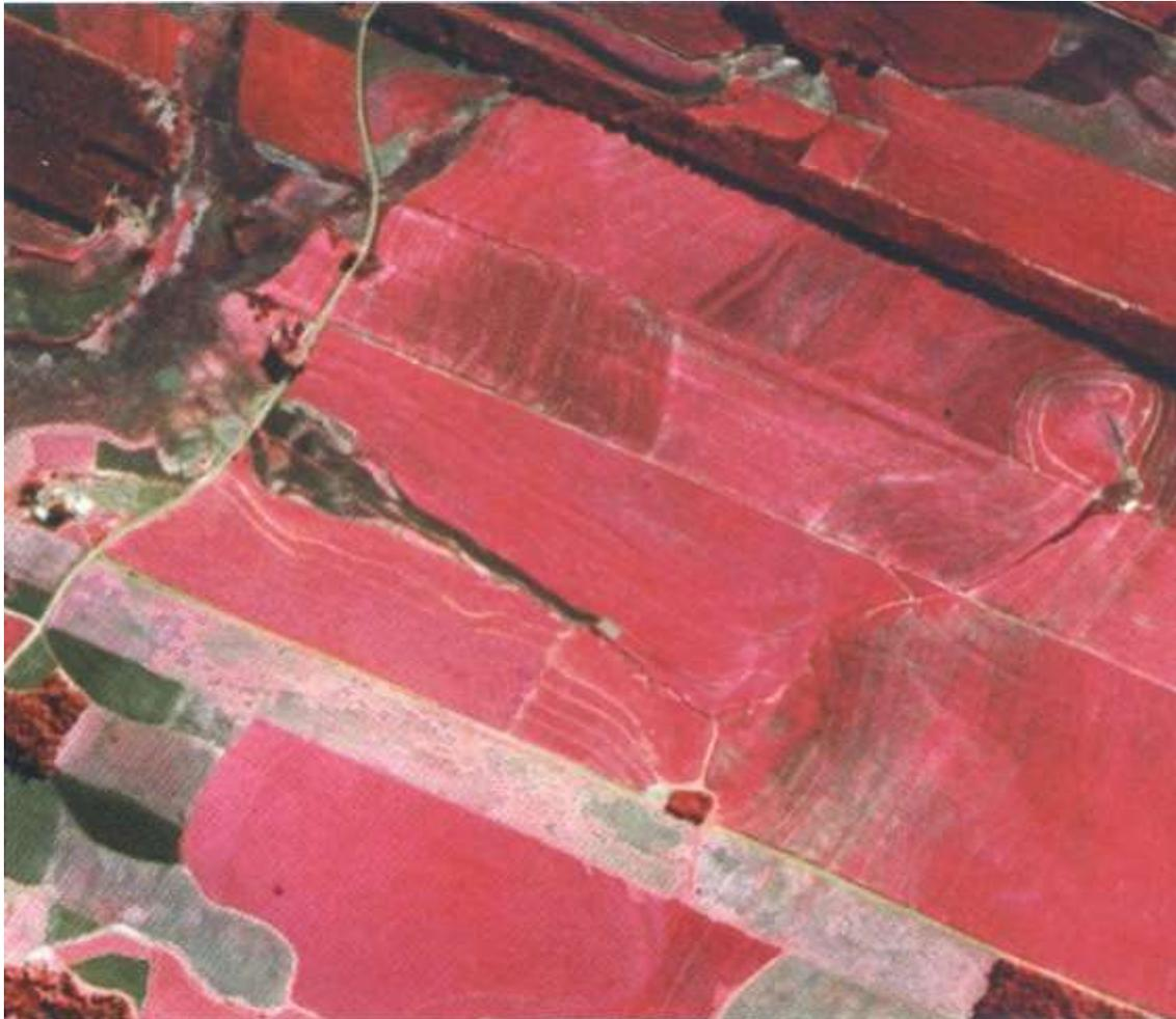
**Fig. 1.12** Fotografia infravermelha falsa-cor de culturas de trigo no município de Tapera (RS). Observe que as parcelas com trigo saudável estão representadas em vermelho mais claro e mais uniforme, enquanto aquelas do trigo atacado pela doença "mal do pé" (*Ophiobolus graminis*) aparecem em vermelho mais escuro mesclado ao verde, que representa o solo. Cortesia: Maurício A. Moreira.
